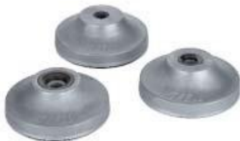
Stellelemente TE-70 mit eingepresster, gehärteter Kegelpfanne zur Aufnahme von maschinenseitig vorhandenen Stellschrauben
